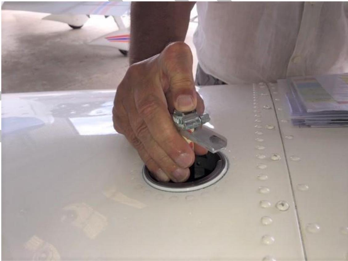
Lire le niveau d'essence de la pipette. Les graduations portées sur le tube permettent de comparer avec l'abaque. Celui-ci vous indiquera la quantité effective de carburant dans le réservoir.
