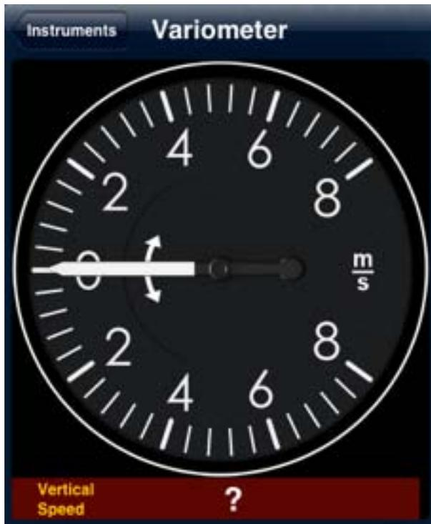
Le variomètre a été conçu pour travailler avec des **périphériques externes**. Toutefois, il peut être utilisé comme avertissement lorsque se produit un changement brusque de la hauteur reçue par l'antenne GPS de l'iPad ou iPhone
