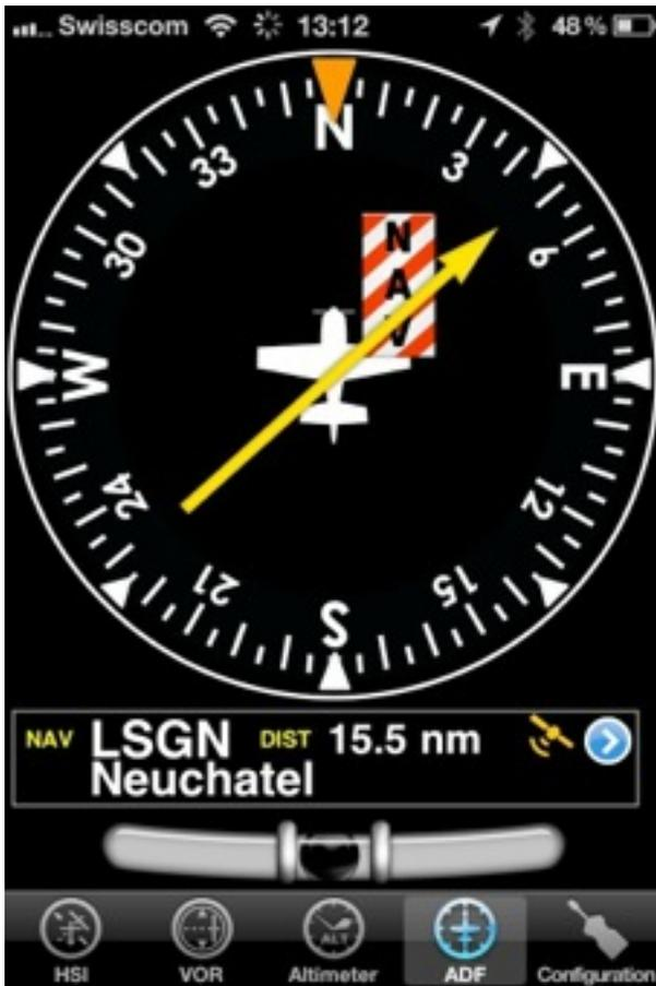
L'instrument ADF dans Air Navigation utilise le cap indiqué par le GPS.
