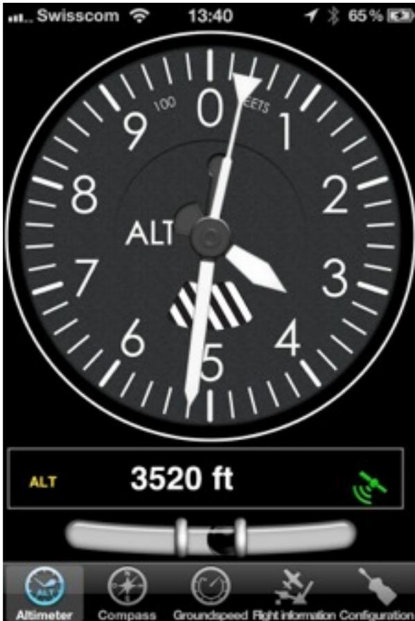
L'altimètre d'Air Navigation est basé sur le GPS. Généralement, le GPS a une précision acceptable. Néanmoins, il ne devrait jamais être utilisé en tant que remplacement d'un altimètre barométrique.
