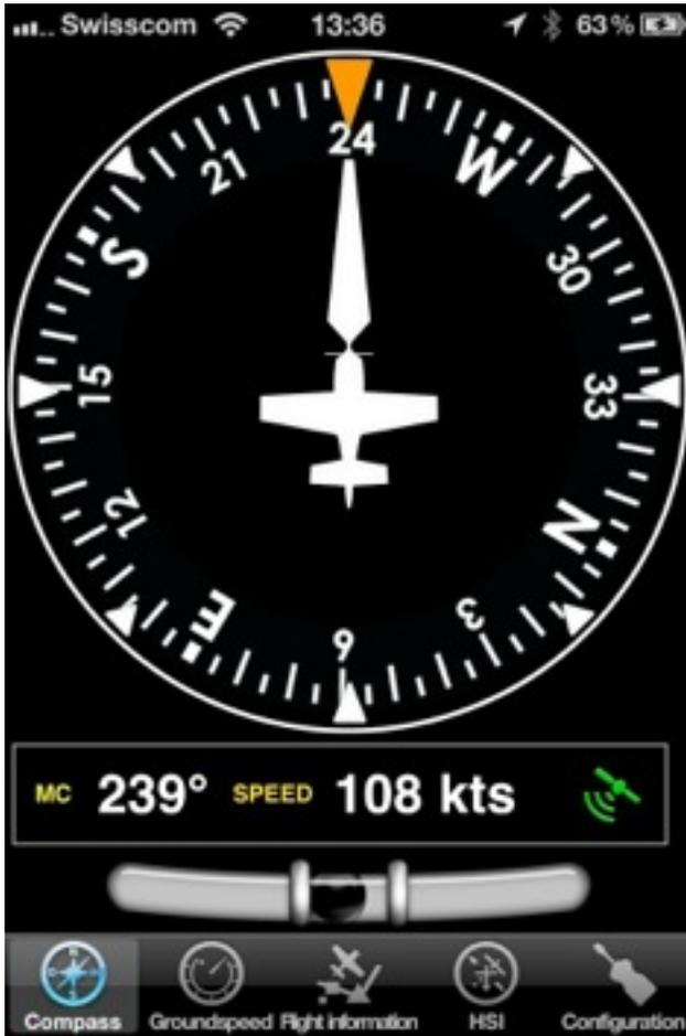
L'instrument "compas" affiche le cap actuel indiqué par GPS (pas l'axe longitudinal de l'appareil) sur un compas virtuel animé. Le cap peut être affiché en mode «nord vrai» ou mode «nord magnétique» selon les réglages.
