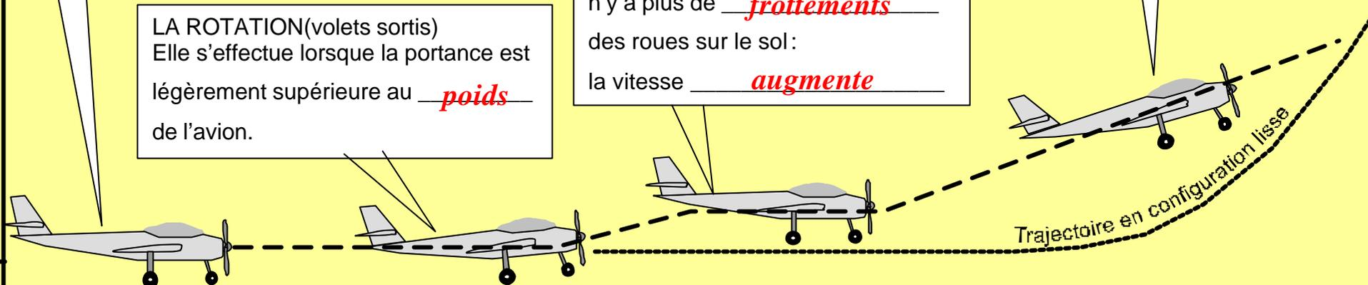
Distance de roulement avec les volets en configuration décollage
